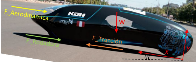
Fig. 3. Diagrama de Cuerpo Libre del vehículo
