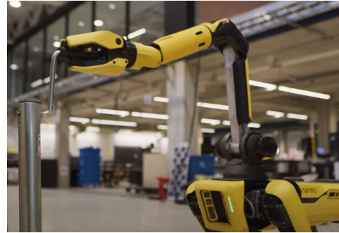
Fig. 1: Robot Spot con su brazo de 6 DoF [1]
