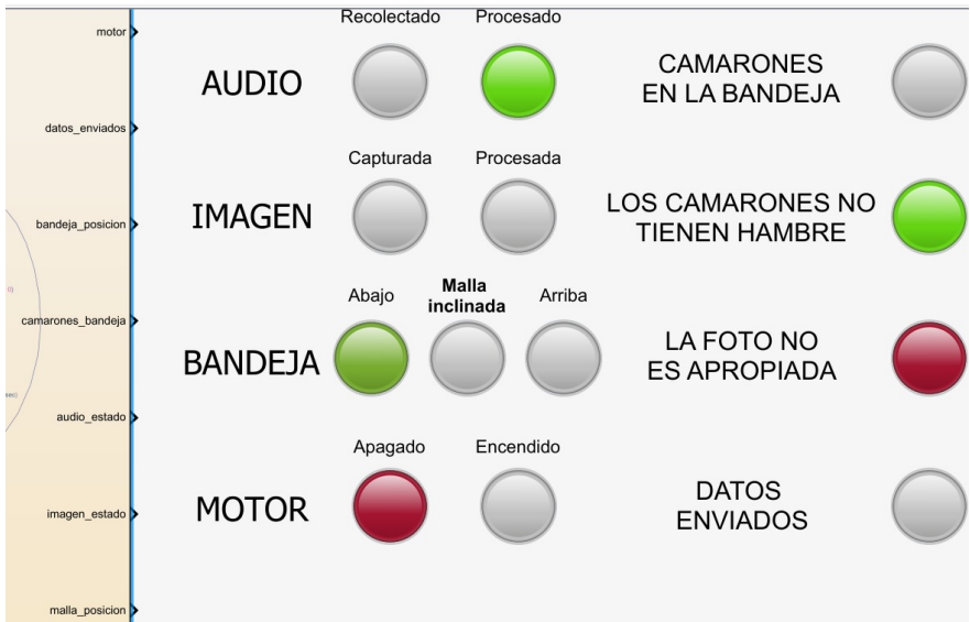
Figura 12: Salidas de la máquina de estados en Stateflow
