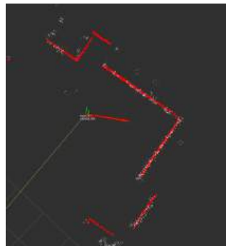
Figure 9: Comparación de localización y escala de nube de puntos de ORB-SLAM 2 y LiDAR
